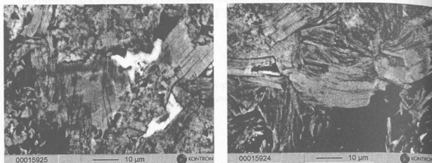
Abb. 1: Textuelle Beziehungen zwischen verschiedenen Heliglimmerphasen in schwach hydrothermal alterierten Gesteinen aus dem Hangenden der Lagerstätte Waterloo (Rückstreuungselektronenstrahlauflnahmen).
