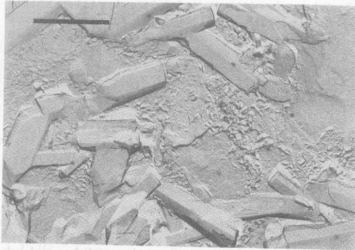
Abb. 8: Portlandzement PZ 35; Neubildungen ca. 1 min. nach der Wasserzugabe; Jet-Verfahren.
